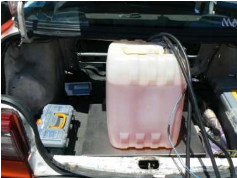
Depósito auxiliar para medir combustible
